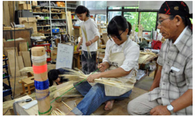
作業台の柱の下にあるロープでほうき草を締め付ける。 それを緩めながら、柱の上に巻いた細い糸や針金を巻き付ける。
