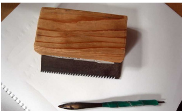
酒井氏の道具。穂先を鋤く鋸を再利用した未剥ぎと、穂を縦に裂く殻裂き。
