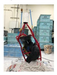
この後、原型を耐火石膏で覆ってしまいます。それを釜で焼くことで、蝋が全て溶け落ち、原型の形をした空洞ができるというシステムです。
