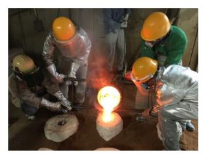
1000 度以上に熱したブロンズを鋳型に流し込みます。近くに立っているだけでも暑い!
